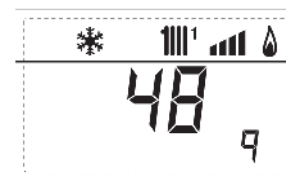
10. zobrazení provozních hodin hořáku x100 (14000)
