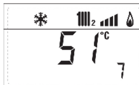
8. zobrazení ionizace na kontrolní elektrodě µA
