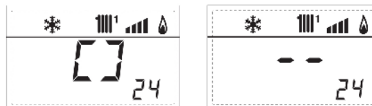
24. zobrazení uzavření ventilu zony 1
