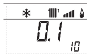
11.zobrazení počtu zapálení hořáku x1000 (97000 a 500)
