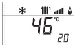
22. Zobrazení funkce čerpadla zóny 1 (ON / OFF)
