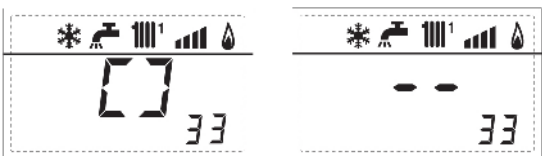
33. zobrazení relé R1 na solárním okruhu (INSOL)
