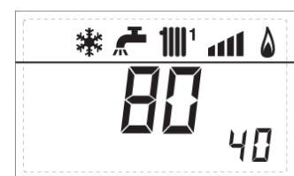
40. hodnota v % výkonu čerpadla
