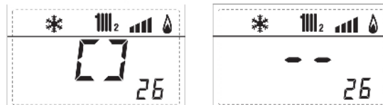
26. Zobrazení stavu hav. termostatu ZONA 2 (ON , OFF)
