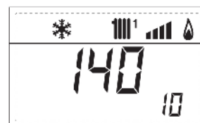
11.zobrazení počtu zapálení hořáku x1000 (97000 a 500)
