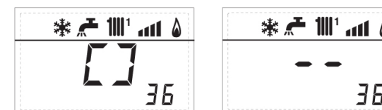
36. Funkce měření průtoku na solárním okruhu (ON/OFF)
