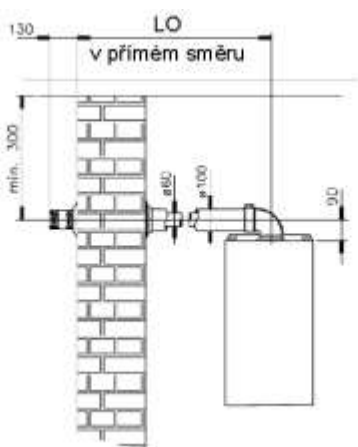
systém horizontálního odtahu spalin
