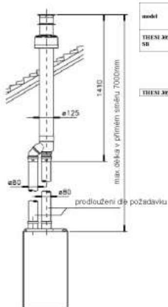
rozdvojené potrubí odtahu spalin spojené pod střešní konstrukcí do sousedního komína
