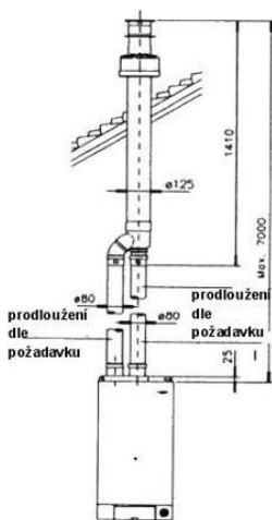
ROZDVOJENÉ POTRUBÍ SE SLUČOVAČEM A SOUŠÝM KOMÍNEM
